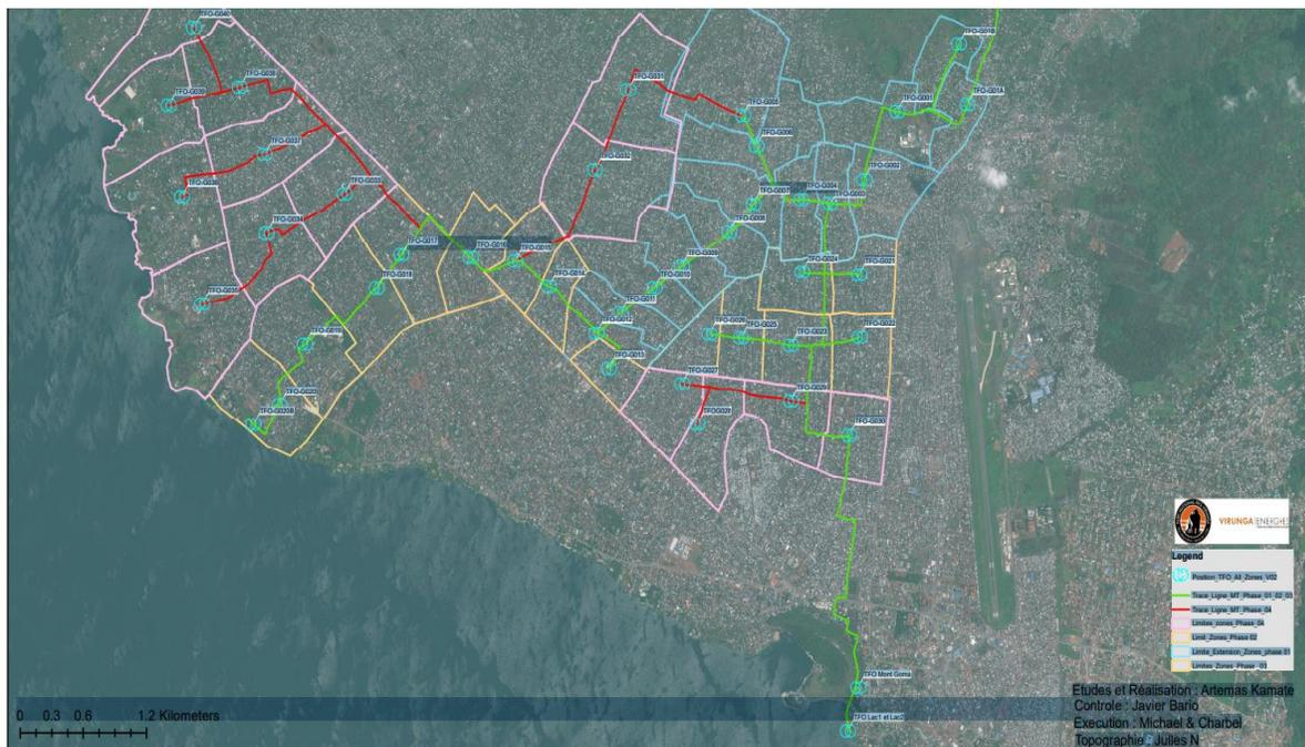
Figure 1 : Réseau de distribution basse et moyenne tension (Grand Goma)
